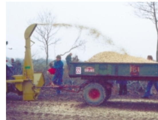
Zur Verwendung im Holzheizkraftwerk oder als Mulchmaterial wird das Knickholz geschreddert. (Foto: Dr. Jürgen Eigner)
