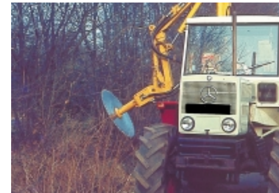
Knickpflege mit der Kreissäge (Foto: Angelika Bretschneider)
